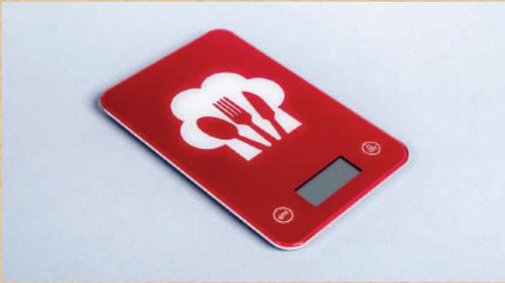
Les balances numériques servent à peser les masses de la matière première, des produits finis et des coproduits au fur et à mesure des étapes de fabrication (purée et jus), en vue de calculer le rendement. Chaque îlot a donc à sa disposition sa propre balance. Il faudra faire attention à bien expliquer le principe de la tare aux élèves avant qu'ils ne réalisent leurs mesures. Chaque balance est rangée dans son carton d'emballage individuel, inclus dans la mallette.
