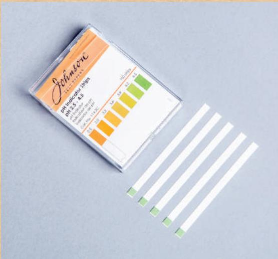
Le papier pH sert à mesurer l'acidité d'un produit (ici le jus de pommes). Les papiers pH classiques permettent de couvrir une gamme d'acidité allant d'un pH 1 (produit très acide) à un pH 14 (produit très basique). Les jus testés en classe ne présentent par une échelle d'acidité aussi élevée. Ainsi, le papier mis à disposition dans la mallette ne couvre qu'une gamme de pH allant de 2,5 à 4,5. Les mesures sont donc plus précises qu'avec un papier pH classique.
