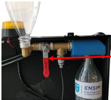
7. Ouvrez la vanne de dépressurisation puis la vanne de remplissage pour remplir la bouteille tampon du volume d'eau souhaité.
