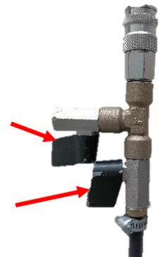
8. Refermez les deux vannes (remplissage et dépressurisation).
