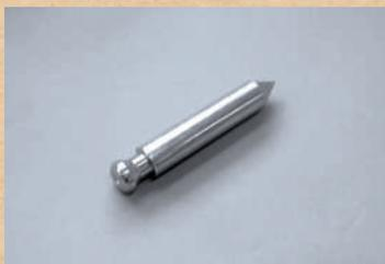
Ces masses sont utilisées au cours de la séance sur la dureté du bois. Lâchées depuis le haut du tube de guidage, elles percutent un échantillon de bois. Plus la résistance à la dureté de l'essence percutée est forte, plus petite sera le diamètre de la marque faite par la masse.
