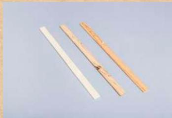
Utilisées à la séance 5 (système pont). Un lot de 3 éprouvettes de flexion contient les essences suivantes : chêne, douglas, peuplier.
