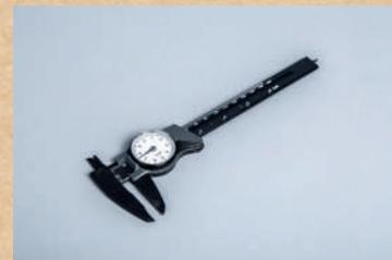
Permet de mesurer précisément les cotes extérieures d'une pièce.
