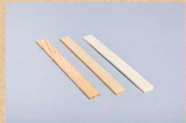
Utilisées à la séance 5 (système potence). Un lot de 3 éprouvettes de flexion contient les essences suivantes : chêne, douglas, peuplier.
