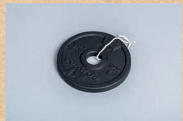
Ces masses sont utilisées lors de la séance sur la résistance mécanique du bois (système pont uniquement). Elles peuvent être suspendues à l'aide d'un cordon ou directement enfilées sur l'éprouvette.
