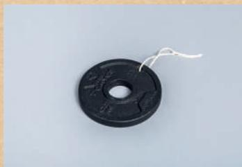
Ces masses sont utilisées lors de la séance sur la résistance mécanique du bois. Pour le système potence, elles sont suspendues via un cordon passé par leur trou central. Pour le système pont, elles peuvent être suspendues à l'aide d'un cordon ou directement enfilées sur l'éprouvette.
