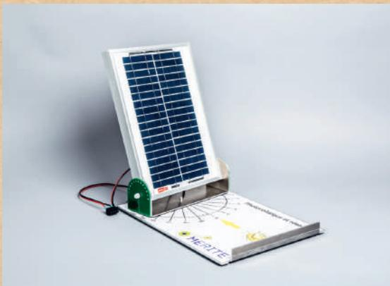
Ce panneau photovoltaïque est monté sur un statif qui lui permet d'être incliné (pour simuler l'inclinaison d'un panneau) et de pivoter (pour simuler la position relative du panneau selon l'heure de la journée). Des rapporteurs permettent une inclinaison et une rotation contrôlées afin de garantir la précision des mesures et la répétabilité des expériences.
