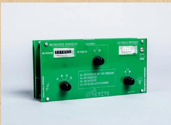
Ce module permet de stocker l'énergie produite par le panneau. Un galvanomètre permet de connaître le stock d'énergie à tout moment. Ce module peut être relié à un autre module de stockage ou à un module de gestionnaire réseau.
