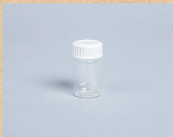
La contenance idéale pour les flacons à vis est de 20 mL (50 mm de hauteur et 27 mm de diamètre). Ces produits sont généralement vendus avec des bouchons, qui sont importants pour les manipulations de la progression pédagogique.
