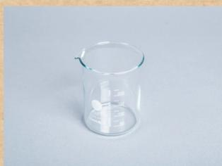
Les béchers contenus dans les mallettes MERITE sont en verre borosilicaté, ont une contenance de 250 ml, une forme basse, un bec et sont gradués.
