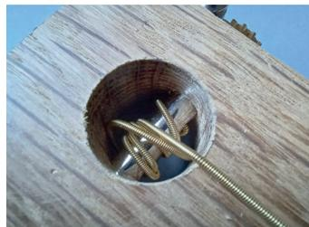
Vue de dessus (face A). Détail de la fixation de la corde sur l'axe de la clé de gauche.
