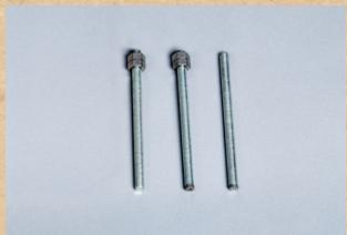
Elles sont utilisées dans le montage du métalophone. La modification de la position des écrous sur deux des barres permet de faire varier la longueur de la barre qui résonne et ainsi de faire varier la hauteur du son produit. On peut utiliser le marteau métallique ou le marteau de piano pour les frapper.
