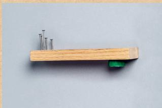
Cet élément est utilisé dans le montage du violon à clous. Il est constitué d'un tasseau de bois, de clous et d'un goulot (formé à partir d'un bouchon en plastique) permettant de visser le **cône en plastique** [24].
