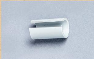
Cet élément est utilisé dans le montage du sifflet creux. Il s'insère dans le **biseau** [26]. Cette pièce est découpée dans un **tube isolant rigide lisse (IRL) en PVC gris** de Ø ext. 16 mm. Il y a 1 tube intérieur dans chaque mallette MERITE et il représente un tronçon de 24 mm de long découpé.
