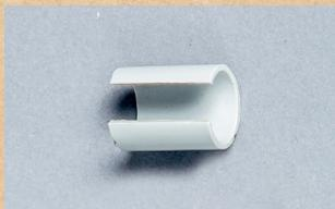
Cet élément est utilisé dans le montage du sifflet creux et du sifflet à tourillon central. Il s'insère autour du **biseau** [26]. Cette pièce est découpée dans un **tube isolant rigide lisse (IRL) en PVC gris** de Ø ext. 16 mm. Il y a 2 tubes extérieurs dans chaque mallette MERITE et ils représentent chacun un tronçon de 24 mm de long découpé.
