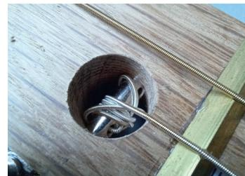
Vue de dessus (face A). Détail de la fixation de la corde sur l'axe de la clé de droite.
