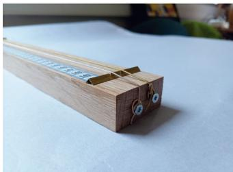
Vue de  $\frac{3}{4}$  avec les faces A, C et F visibles. Détail de la fixation des cordes sur les vis.
