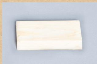
Le chevalet rectangulaire présent dans la mallette mesure environ 110\*150\*15 mm. Il peut être construit à partir de n'importe quelle planche de bois d'épaisseur 15 mm (environ). Les chevalets fabriqués pour les mallettes MERITE l'ont été à partir d'une volige traitée en sapin de 105\*3000\*14 mm.
