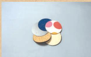
Ces échantillons circulaires sont utilisés lors des expériences sur la perméabilité. Leur diamètre (70 mm) doit être un peu plus grand que celui des récipients en plastique [7], car ils sont destinés à être posés dessus. Le plus pratique est d'utiliser une découpeuse laser pour former des disques parfaits. Le fichier de découpe est fourni sur [www.projetmerite.fr](http://www.projetmerite.fr).
