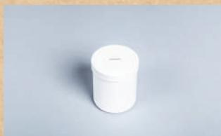
Utilisé lors de la séance sur la perméabilité et celle sur la conduction thermique. Il est accompagné d'un couvercle muni d'une fente, dans laquelle on peut insérer une éprouvette. Les dimensions importent peu (les récipients des mallettes MERITE ont un diamètre intérieur de 65 mm et une hauteur de 80 mm. La fente est à réaliser soi-même avec un découpeuse laser (fichier sur [www.projetmerite.fr](http://www.projetmerite.fr)) ou simplement un cutter.
