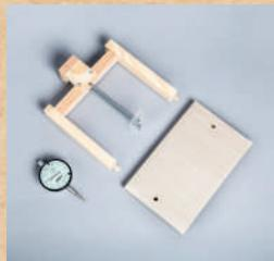
Le dispositif est rangé en 2 parties dans la mallette : une base en bois munie de deux trous et un ensemble potence / guides de positionnement / support des masses muni de deux tourillons, à encastrier dans les trous de la base. Il permet de mesurer la rigidité d'échantillons de matériaux que l'on appelle éprouvettes. Il existe 2 options possibles pour fabriquer cette référence. La première option - celle réalisée pour les mallettes MERITE - nécessite plus de
