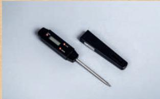
Ces thermomètres sont utilisés lors de la séance sur la conduction thermique, afin de mesurer la température des matériaux. Il est conseillé de se procurer des thermomètres numériques de poche de précision avec une amplitude de fonctionnement allant de 0 à 50°C.
