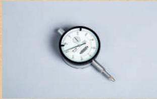
Intégré au banc de flexion au niveau du support dédié et bloqué à l'aide de la vis à six pans, cet outil permet de comparer la rigidité des différents matériaux testés en mesurant la flèche induite par l'ajout des masses.
