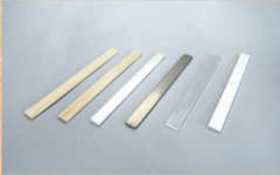
Ces lamelles de matériaux, toutes à la même dimension (15\*3\*170 mm), sont utilisées à la fois pour les expériences sur la rigidité et la conduction thermique. La réalisation soi-même de certaines éprouvettes (notamment celles de PMMA et de PVC) est envisageable. Il est conseillé, pour les autres, de confier la réalisation à un prestataire.
