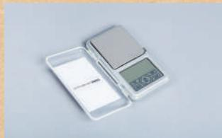
Elle permet de mesurer des masses comprises entre 0,01 g et 200 g. On l'utilise pour mesurer et comparer la masse des différents échantillons lors de la séance sur la rigidité.
