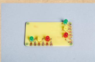
Cette carte permet l'expérimentation autour de l'allumage de 2 rangées de 3 LEDs. Elle est utilisée pour simuler deux feux de circulation lors des expérimentations. Ses composants sont les mêmes que pour les deux autres cartes d'expérimentation à LEDs.
