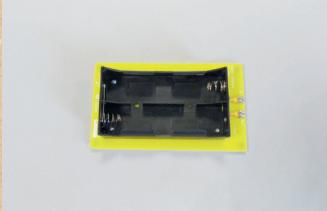
On y insère les 4 piles et on le relie aux moteurs, à la carte d'interface ou aux cartes d'expérimentation. Il permet d'alimenter le robot lors des expérimentations.
