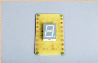
Cette carte permet une situation de recherche intéressante : l'affichage d'un chiffre ou d'un motif nécessite l'allumage d'un grand nombre de LED (chaque segment est une LED). Cela permet un débat sur le code utile pour piloter la carte par l'ordinateur et ce qui est communiqué à l'utilisateur.
