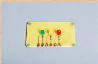
Cette carte permet l'expérimentation autour de l'allumage de 3 LEDs. Elle est utilisée pour simuler un feu de circulation lors des expérimentations. Ses composants sont les mêmes que pour les deux autres cartes d'expérimentation à LEDs.
