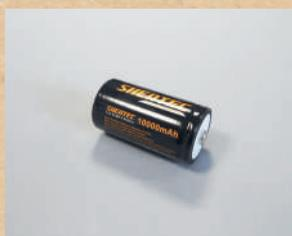
Ces piles LR20, rechargeables, sont insérées dans le **bloc d'alimentation** [15]. Elles doivent être compatibles avec le **chargeur** [8] et le bloc d'alimentation. Prendre des piles 1,2 V et 10000 mAh.
