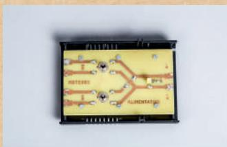
Principalement destiné à la commande manuelle des moteurs, il permet aussi des observations intéressantes avec les cartes d'expérimentation à LEDs, et ainsi poursuivre la construction du concept de sens du courant. Placé entre le bloc d'alimentation et les moteurs, il permet la rotation des moteurs dans les deux sens au moyen des commutateurs.
