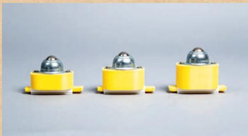
**La mallette contient 3 roulettes à bille :** haute, médium et basse. Les roulettes à bille assurent la stabilité du robot quelle que soit sa trajectoire. La hauteur des socles permet de conserver le châssis à peu près horizontal quelles que soient les tailles de roues choisies. Elles sont équipées de glissières pour pouvoir être déplacées le long du châssis. Comme pour les moteurs, une cale couissant dans la glissière peut la fixer à l'emplacement choisi.
