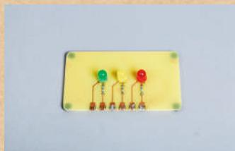
Cette carte permet l'expérimentation autour de l'allumage de 3 LEDs. Elle est utilisée pour simuler un feu de circulation lors des expérimentations. Ses composants sont les mêmes que pour les deux autres cartes d'expérimentation à LEDs.
