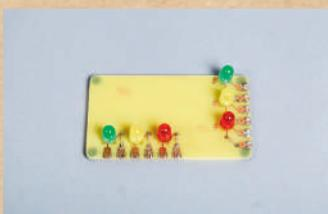
Cette carte permet l'expérimentation autour de l'allumage de 2 rangées de 3 LEDs. Elle est utilisée pour simuler deux feux de circulation lors des expérimentations. Ses composants sont les mêmes que pour les deux autres cartes d'expérimentation à LEDs.
