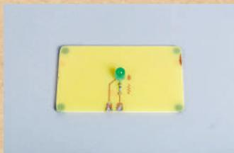
Cette carte permet l'expérimentation autour de l'allumage d'une LED. La broche reliée à la résistance doit être connectée à la borne + : une inversion n'est pas dangereuse mais ne permettra pas l'allumage de la LED. Ceci est valable pour toutes les cartes d'expérimentation. Cette constatation est à comparer au comportement d'une ampoule (allumage quelque soit le branchement) et du moteur (le sens de rotation est fonction du branchement).
