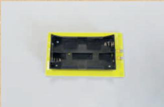
On y insère les 4 piles et on le relie aux moteurs, à la carte d'interface ou aux cartes d'expérimentation. Il permet d'alimenter le robot lors des expérimentations.
