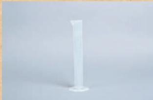
Les éprouvettes graduées incluses dans les mallettes MERITE ont une contenance de 50 mL.
