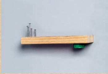
Cet élément est utilisé dans le montage du violon à clous. Il est constitué d'un tasseau de bois, de clous et d'un goulot permettant de visser le cône en plastique.
