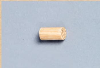
Cet élément est utilisé dans le montage du sifflet à tourillon central. Il s'insère dans le biseau.
