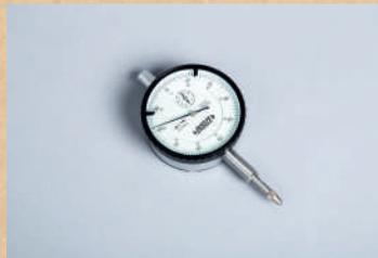
Intégré au banc de flexion, il sert à mesurer la rigidité des éprouvettes.
