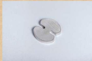
Chaque masse pèse 150 g. Elles sont déposées dans le support des masses du banc de flexion pour étudier la rigidité des éprouvettes selon la charge.
