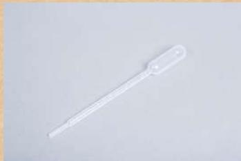
Utilisée lors de la séance sur la perméabilité, pour faire couler délicatement de l'eau sur les éprouvettes à tester.
