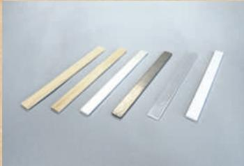
Utilisées pour les tests sur la rigidité et la conduction thermique. Il y en a 6 par lot : pin, chêne, aluminium, acier, PMMA et PVC.
