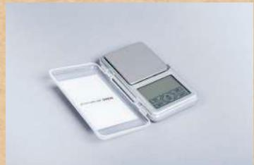
Cette balance permet de mesurer des masses comprises entre 0,01 g et 200 g.
