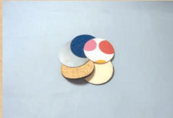
Ces éprouvettes circulaires sont utilisées pour en tester la perméabilité. Il y en a 5 par lot : acier, balsa, denim, liège et plastique.
