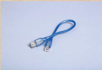
Ces câbles permettent de relier un ordinateur à la carte Arduino (et par extension tout le circuit de montage), afin d'y téléverser des programmes.
