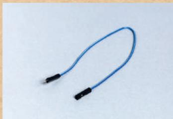
Ces fils de connexion possèdent une extrémité mâle et une extrémité femelle (dans laquelle une extrémité mâle peut être insérée). Ils peuvent ainsi servir à réaliser des rallonges.
