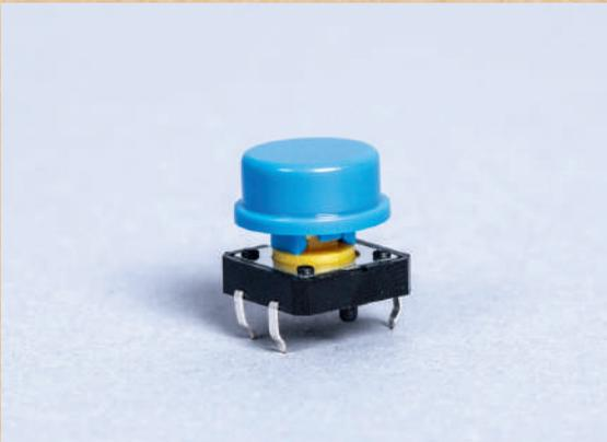
Il s'agit d'un capteur de contact. Il permet de réaliser un montage dont les actions vont varier selon une action physique directe de l'utilisateur (ici, l'appui sur le bouton). Il donne l'information sur son état : « appuyé » (le contact est fait) ou « relâché » (le contact n'est pas fait).
