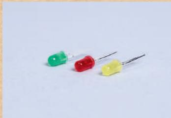
Elles sont composées d'une patte longue (+) à brancher à la tension la plus haute et d'une patte courte (-) à brancher à la tension la plus basse. Il est nécessaire d'ajouter une résistance dans les montages contenant une DEL (1/DEL) pour éviter à cette dernière de griller.
