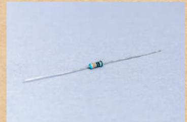
Ajoutée au montage, la résistance permet de limiter la tension aux bornes des DEL et ainsi d'éviter leur dégradation. Il n'y a pas de sens de branchement pour les résistances, mais il faut veiller à bien les monter en série (et pas en parallèle) avec les DEL.
