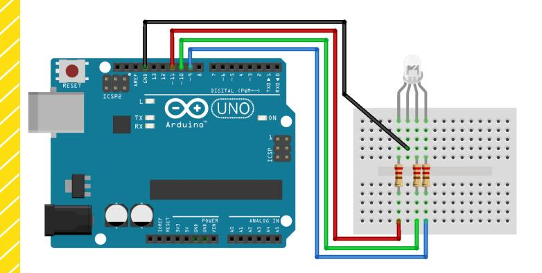
Une DEL RVB possède 4 pattes. Il y a 2 catégories de DEL RVB, les RVB à cathode et les DEL RVB à anode. Tu vas utiliser une DEL RVB à cathode. Tu devras connecter la patte la plus longue au GND de la carte Arduino. Les trois autres pattes correspondent aux 3 couleurs : Rouge, Vert, Bleu. Tu devras les connecter sur les broches 9, 10 et 11.
