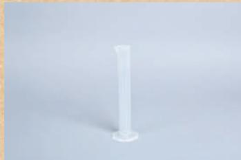
Ces éprouvettes de 50 mL permettent de mesurer des volumes de liquides.
