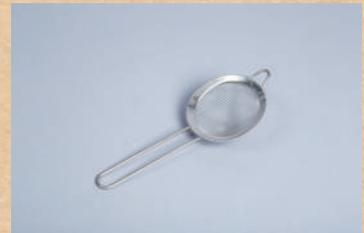
Elles permettent de réaliser une étape de filtration pour retenir des solides dont la taille est supérieure à 1 mm.
