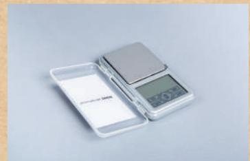
Cette balance permet de mesurer précisément des masses comprises entre 0,01 g et 200 g.
